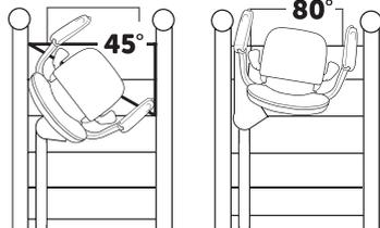
**REMINDER - MAKE SURE THE SEAT IS LOCKED INTO POSITION FACING AWAY FROM THE STAIRCASE BEFORE GETTING ON OR OFF THE STAIRLIFT.**
